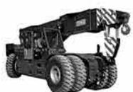
**Installation électrique** Tension de service 24V. Alternateur 1680W, N° 2 batteries de 12V 180 Ah; unité électronique connectée par système CAN-BUS pour le control de la capacité de levage, des les fonctions de suspension et de la vitesse en conformité de la charge levée.
